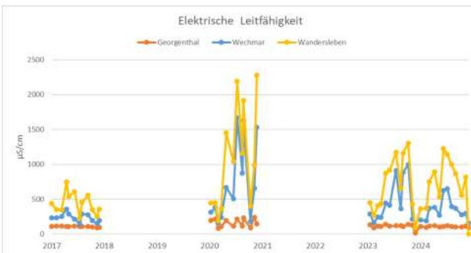
Abbildung 47: Vergleich der Messwerte für die elektrische Leitfähigkeit des Wassers in der oberen und mittleren Apfelstädt
